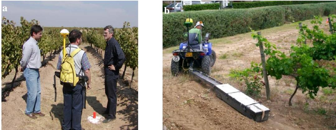
**FIGURA 2.** (a) Geo-referenciación de un cuartel vitícola utilizando un GPS diferencial y (b) Monitoreo de la variabilidad espacial de suelo utilizando un medidor de conductividad eléctrica.
